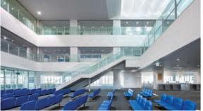
運転免許試験場の再整備から維持管理及び附帯事業を一体として実施するPFI事業である。敷地形状と周辺環境の分析に基づく合理的な配置計画、周辺住宅に配慮した外装計画、2つの長方形をV字形状で連結し、機能性・効率性の最大化を図る平面計画とした。柔らかな光に包まれる膜天井の吹抜空間を中心に、多様な来場者の目的別動線を考慮した行き先がわかりやすい空間の構築と諸室配置、来場者用と職員・管理者用動線の分離、サイン計画・ユニバーサルデザインの充実、試験室における放射整流空調の採用など、全ての人にやさしく・使いやすいインクルーシブデザインの手法を取り入れた運転免許試験場を実現した。
