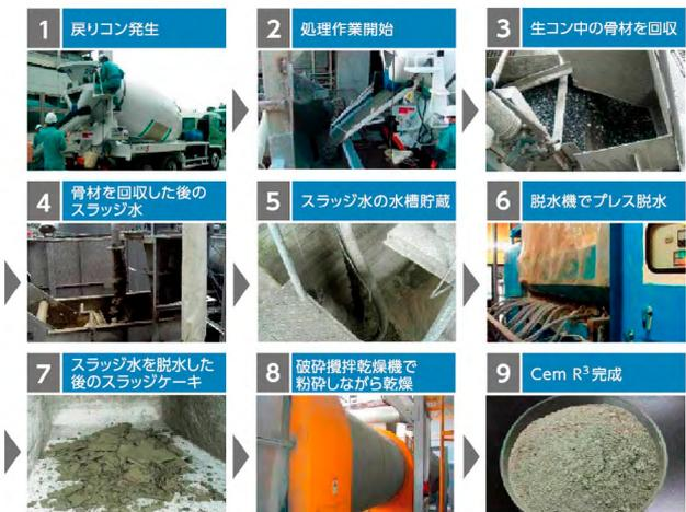
Fig.5 CemR<sup>3</sup> の製造工程 (Production Process of CemR<sup>3</sup>)
