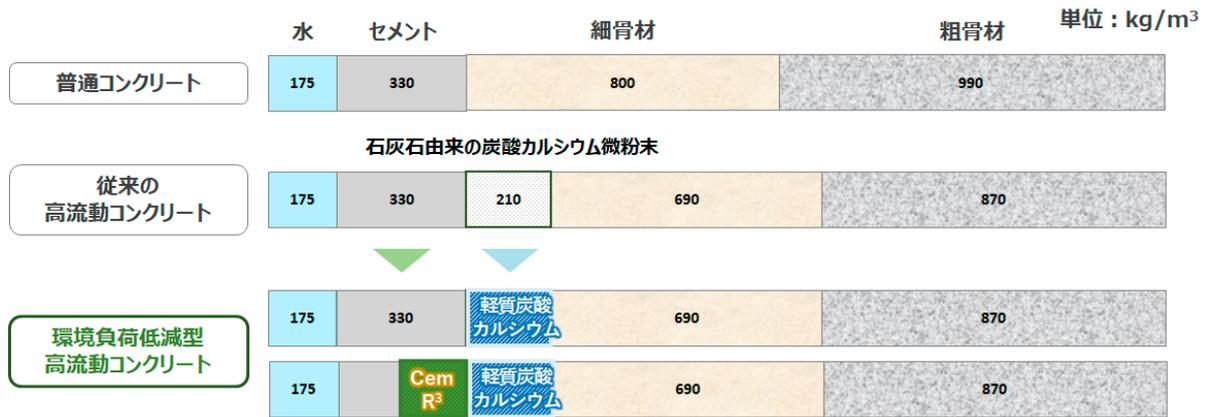
Fig.8 環境負荷低減型高流動コンクリートの配合設計の一例
