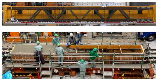
(c) 実験状況 (上: コンクリート打込み前 下: コンクリート打込み状況)
