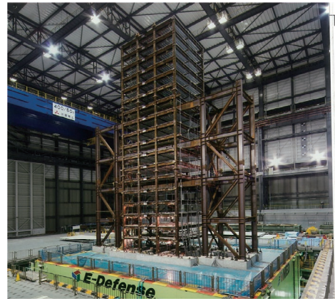
(b) 世界最大の工学実験装置の一つ“E-ディフェンス”で 行われた大型模型の振動台実験 (Shaking Table Test of Large Building Model Using “E-Defense”, One of the World's Largest Engineering Test Rigs)
