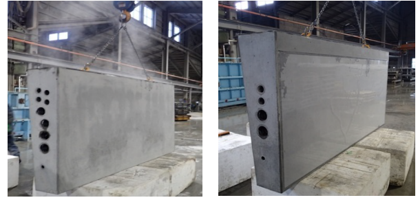
シート養生なし シート養生あり Photo 2 脱型状況 (Unframed Situation)
