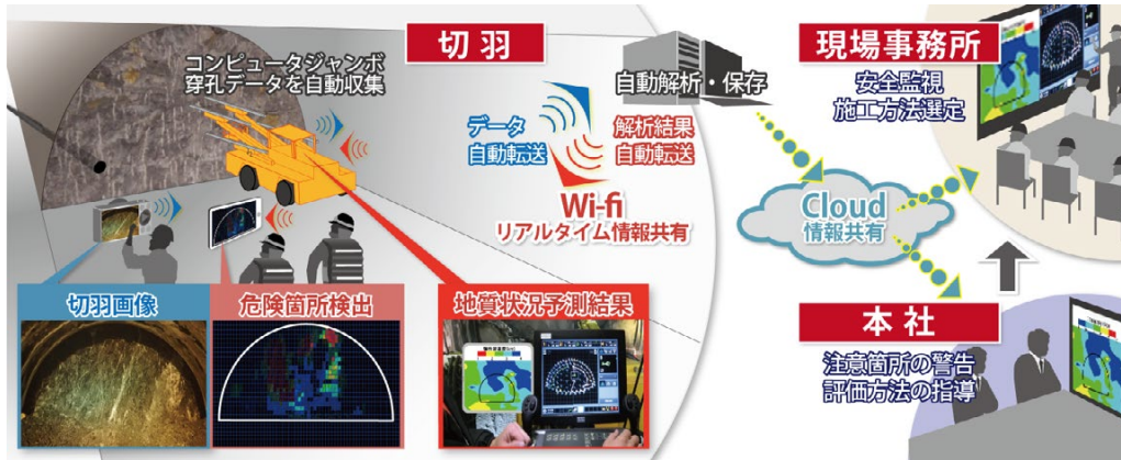
Fig.1 スマート切羽ウォッチャーの概要 (Schema of Smart Face Watcher)
