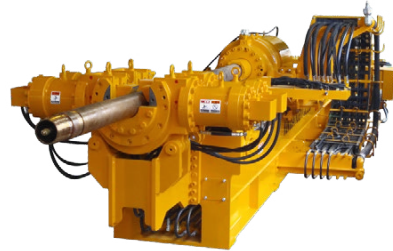
Photo 1 超長尺コントロールボーリングマシン 4) (Directional Drilling Machine)
