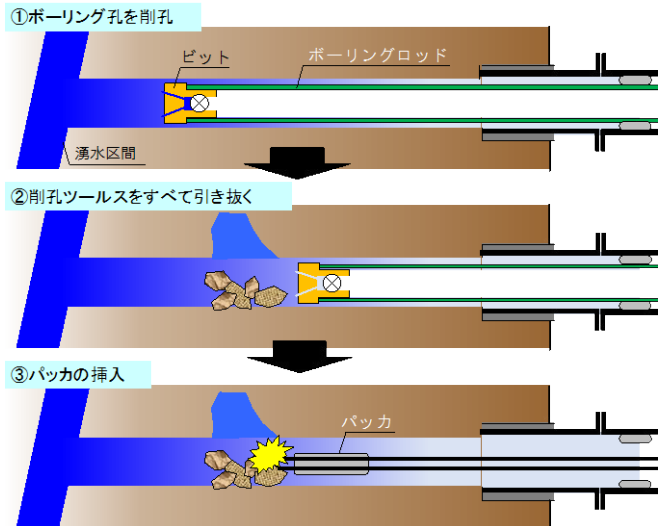
Fig.7 従来のパッカ設置方法に伴う孔崩れの発生 (Conventional Method)
