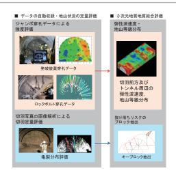
リアルタイム切羽評価システム Real-time Evaluation for Tunnel Face System
