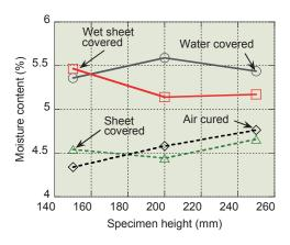
冠水養生によるコンクリート内部含水率の向上 Maintaining Moisture Content in Concrete by Water Covered Curing Similar to Water Curing
