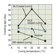
低収縮高炉セメントと水中養生の組合せによる抵抗性の向上 Significant Enhancing Eeffects of Combining Low Shrinkage BFS and Water Curing on Shrinkage Cracking Resistance
