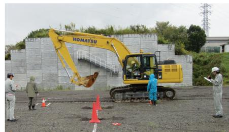
Photo 1 重機作業時の振動計測実験 (Field Test on Vibration Measurement)
