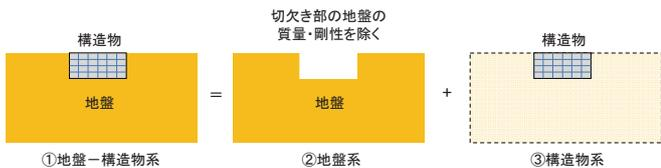
Fig.6 動的サブストラクチャー法の概念図
