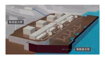
凍土壁は、マイナス30度の冷却液を移送管で圧送し、約1m間隔で地中に設置した長さ約30mの凍結管の中を循環させ造成します。地下に多数存在する埋設物の両脇に複数の凍結管を設置することで、埋設物の上下の地盤にも凍土壁を造成し、地下水の流入を防ぎます。
